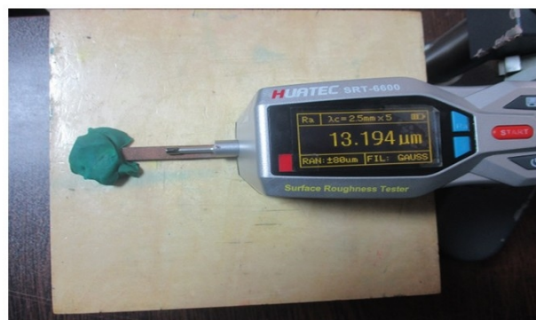
شکل 7- نمایی از دستگاه اندازه گیری صافی سطح.
